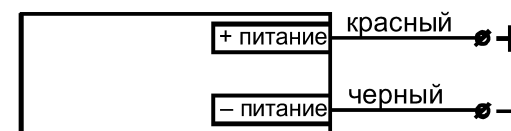
Рис.3. Схема подключения излучателя МикРА Ф14И.
