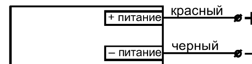
Рис.3. Схема подключения излучателя МикРА Ф15И.
